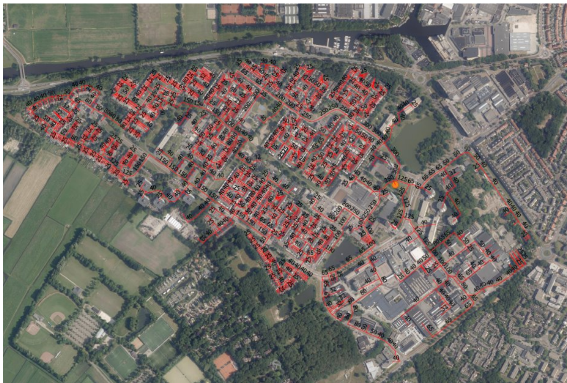
Figuur 19 Projectie schetsontwerp warmtenet op Kerkelanden. De getallen geven de leidingdiameter aan in millimeters exclusief isolatie.
